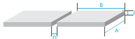
A=širina pločice (mm), B=širina pločice (mm), C=debljina pločice (mm), D=širina fuge (mm), F=gustina (kg/dm<sup>3</sup>)
